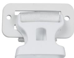
Conformément à la norme NF P 90-308, ces platines supports sont livrées en quantité proportionnelle à la taille du tablier de lames et à la forme de la piscine. Elles sont fixées sur la paroi opposée à l'axe d'enroulement. **Les platines doivent être fixées en dessous de la margelle et au dessus du niveau d'eau habituel.** Utiliser le jeu de vis et chevilles spéciales prévu à cet effet.
